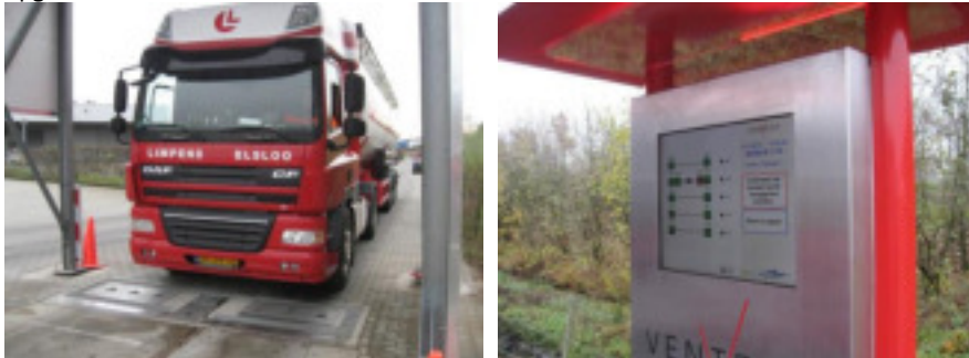
De truck rolt stapvoets over de Ventech bank en enkele meters verderop kan de chauffeur de resultaten, op oog hoogte, aflezen.
