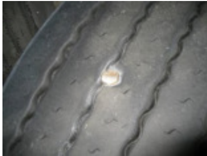
Een zeskantbout in het loopvlak van een trailerband
