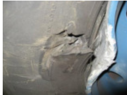
Een ernstige impact schade aan bandwang en velg
