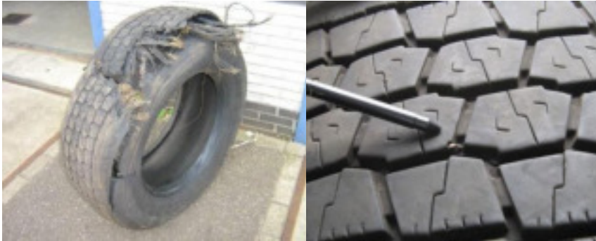
Deze vooras klapband heeft gelukkig slechts (beperkte) materiële schade veroorzaakt. Een lekke band door een inrijding met een spijker
