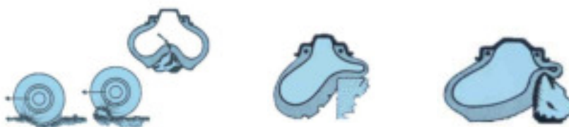
Enkele voorbeelden van een impact beschadiging op het loopvlak en de zijkant van een band
